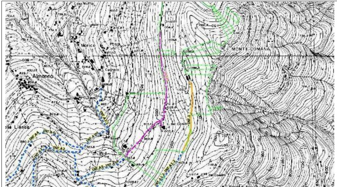
**RES.P1** – Tracciato molto funzionale all'utilizzo dell'intera compresa forestale, di fatto prosecuzione del tracciato esistente, allargando il sedime del sentiero esistente. Da un sommario sopralluogo non appaiono problemi costruttivi particolari. In soprassuolo si presta ad una gestione attiva. Utile anche per funzione AIB. Possibile un suo prolungamento ulteriore per servire intero versante.
